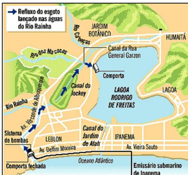
**Figura 34. Esquema das estruturas de esgotamento da Lagoa Rodrigo de Freitas.**
