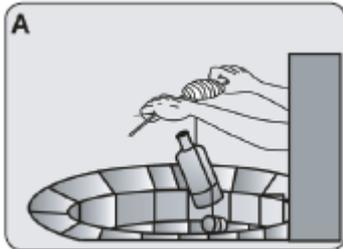
Descer lentamente o cordão sem permitir que o frasco toque nos lados do poço.
